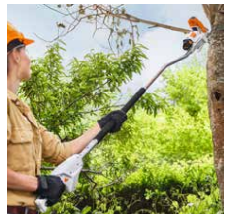
Mit festem Stand auf dem Boden: Ein Akku-Gehölzschnيدر mit Verlängerung ermöglicht das Arbeiten in luftiger Höhe, ohne auf eine wackelige Leiter klettern zu müssen. Foto: DJD/Andreas Stihl
