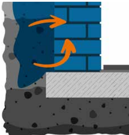
Eine fehlende oder defekte Außenabdichtung lässt Feuchtigkeit aus dem Erdreich ungehindert in das Mauerwerk eindringen
